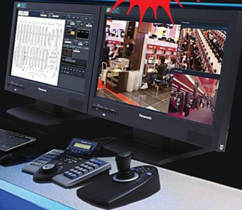
WV-ASM300 yazılımı, 16:9, 4:3 ve 9:16 koridor formatında en-boy oranına sahip video akışlarının aynı ekran üzerinde görüntülenmesini destekler. LIVE (CANLI), MAP (HARİTA) ve OPERATION (OPERASYON) monitörlerinin tümü 4K çözünürlüğü destekler.
